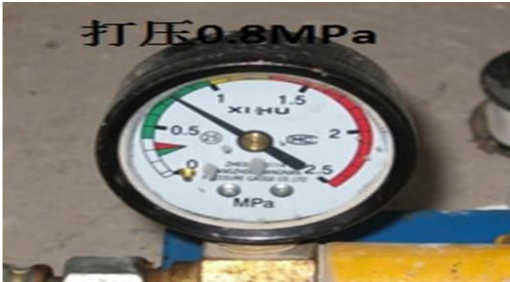
老中医提醒：试水压力为供水压力的 1.5 倍，且  $\geq 0.8\text{Mpa}$ ，恒压 1 小时，掉压在正负 0.5 个压力。
